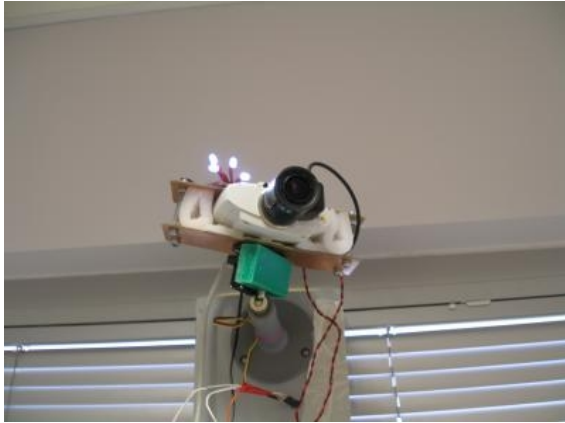
Joonis 7: Arduino abil juhitava kaamera mehhaanika
